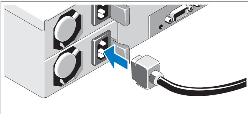
Conecte los cables de alimentación al sistema y, si se utiliza un monitor, conecte el cable de alimentación correspondiente al monitor. Conecte el otro extremo de los cables de alimentación a una toma eléctrica con conexión a tierra o a otra fuente de energía, como por ejemplo un sistema de alimentación ininterrumpida (SAI) o una unidad de distribución de alimentación (PDU).
