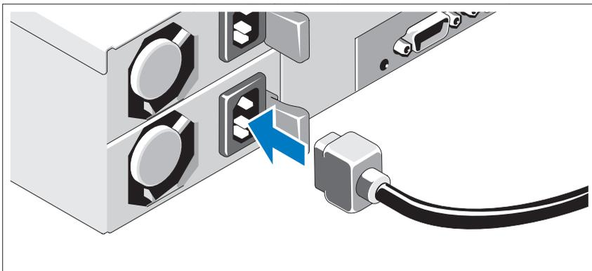
Conecte o(s) cabo(s) de alimentação ao sistema e, se for usado um monitor, conecte o(s) cabo(s) de alimentação ao monitor. Conecte a outra extremidade dos cabos de alimentação a uma tomada elétrica aterrada ou a uma fonte de energia separada, por exemplo, uma fonte de alimentação ininterrupta (UPS) ou uma unidade de distribuição de energia (PDU).
